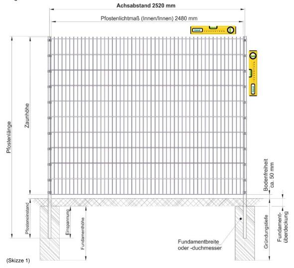
Bei den Pfostenfundamenten handelt es sich um eingebettete Punktfundamente. Hierfür sind Löcher mit einem Durchmesser von 30-40 cm und eine Tiefe von 60-80 cm notwendig, damit die Pfosten frostsicher sitzen. In die Pfostenlöcher sollte eine 10 cm dicke Schicht aus Kies eingefüllt werden, die als Drainage und Korrosionsschutz dient. Die Fundamente sind immer aus Beton der Güte C25/30 zu gießen.
